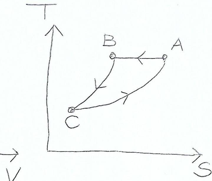
Le cycle est décrit dans le sens trigonométrique
