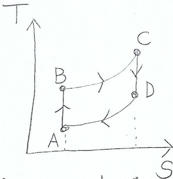
Le cycle est décrit dans le sens contraire au sens trigonométrique  $\Rightarrow$  cycle moteur
