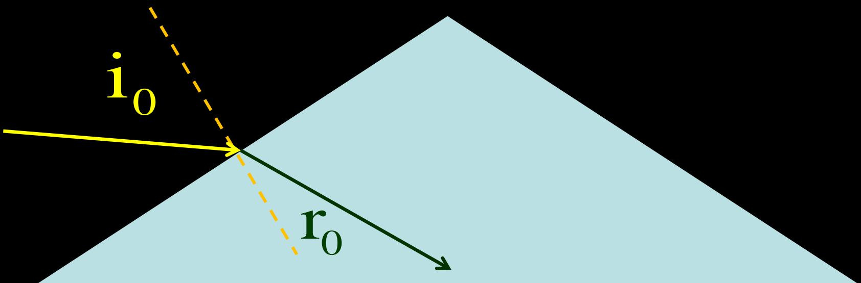
La condition  $r > r_0$  entraîne la **condition imposée** au rayon incident :  $i > i_0$ , et  $i$  ne peut varier qu'entre  $i_0$  et  $\pi/2$ , autrement dit :
