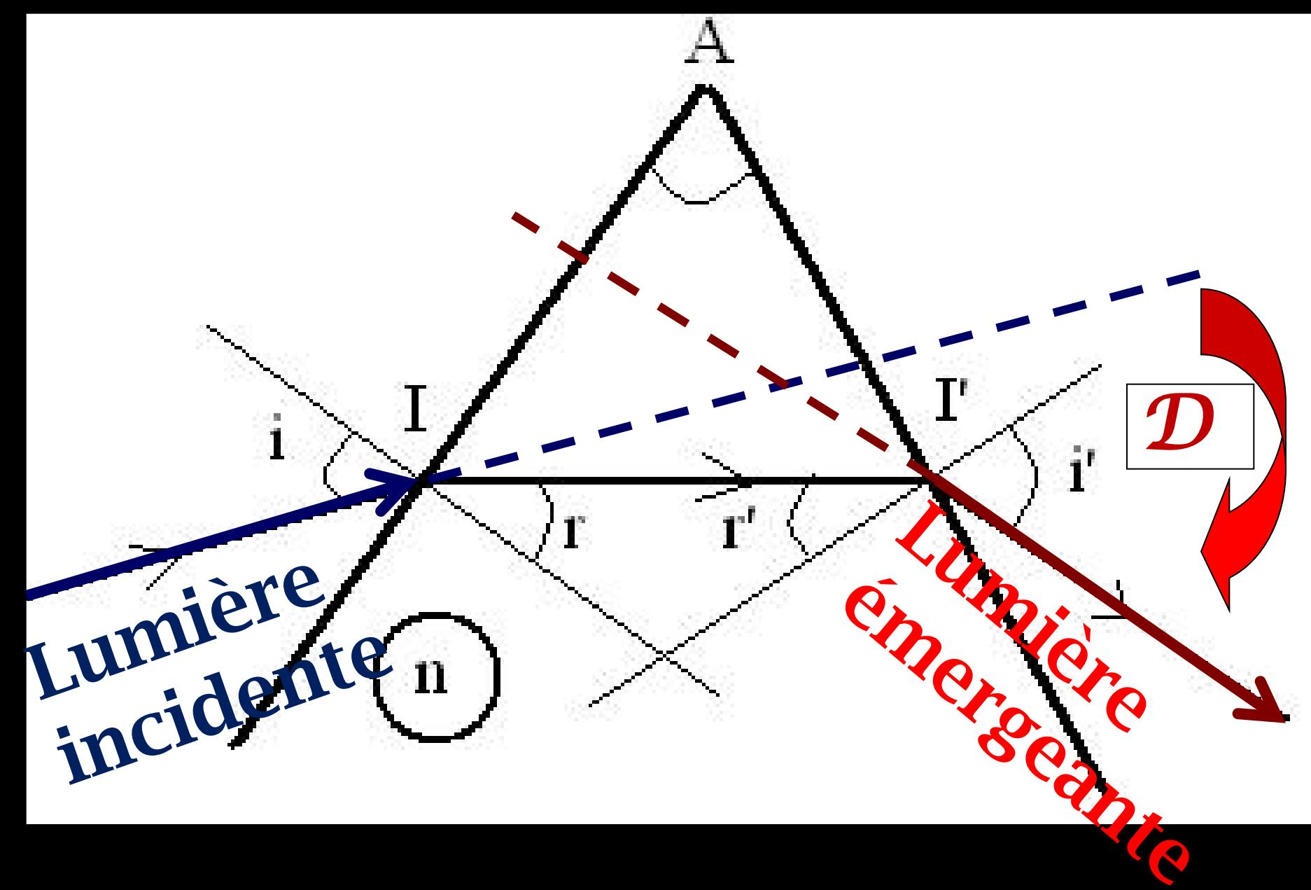
Déterminer la **marche** d'un rayon lumineux à travers un **prisme**, revient à déterminer **les relations mathématiques** qui lient les paramètres :
