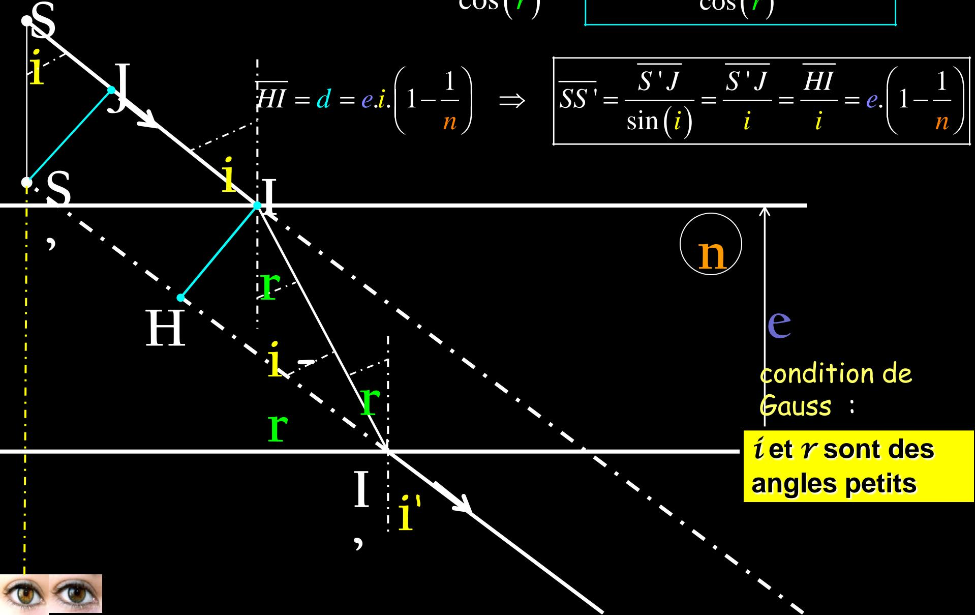
La position de l'image se déduit de celle de l'objet par une translation normale aux faces, d'une amplitude constante, indépendante de la position de l'objet, est égale
