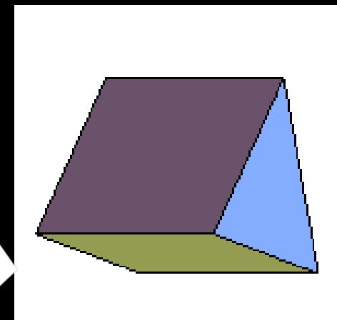
Si l'on opère avec de la lumière blanche, le faisceau émergent n'est plus cylindrique, outre la déviation, il subit une décomposition en faisceaux colorés : il y a dispersion de la lumière complexe en lumières simples.
