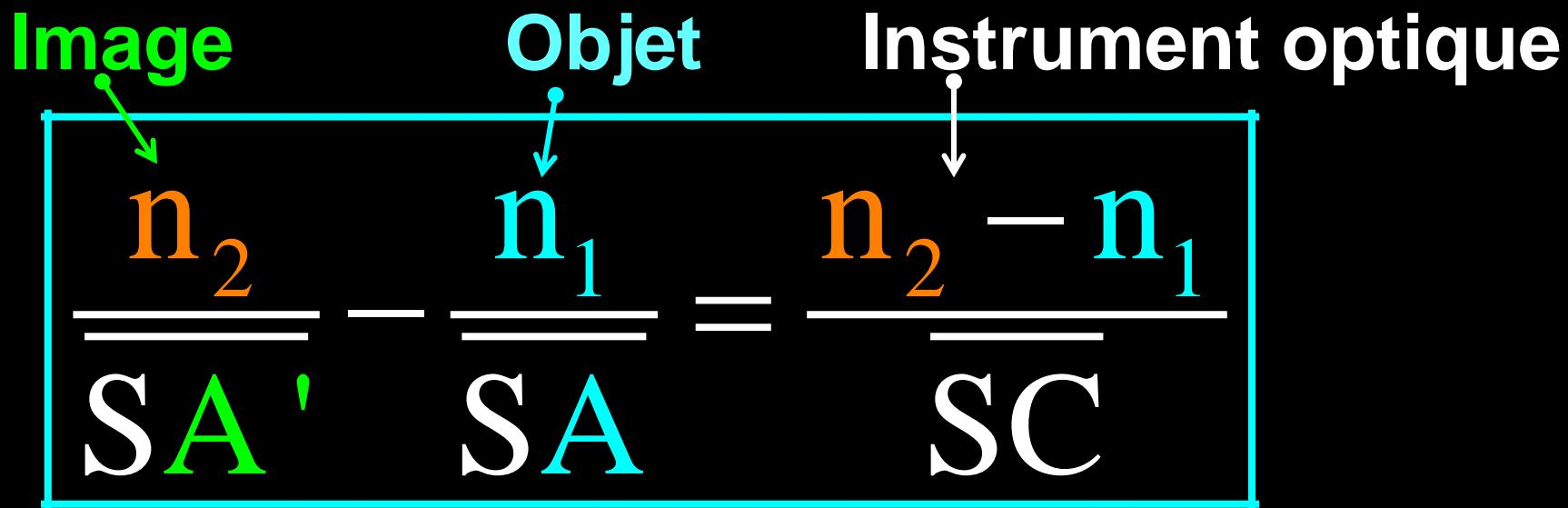
**Formule de Descartes : relation de conjugaison d'un dioptre sphérique ( $S, C, n_1, n_2$ ) dans les conditions de l'approximation de Gauss.**
