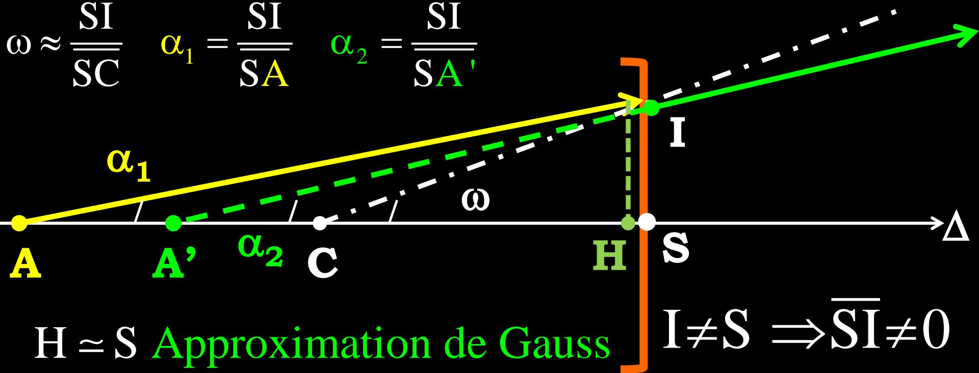
$$i_1 = \omega - \alpha_1 \quad \text{et} \quad i_2 = \omega - \alpha_2 \quad n_1 \cdot i_1 = n_2 \cdot i_2$$
