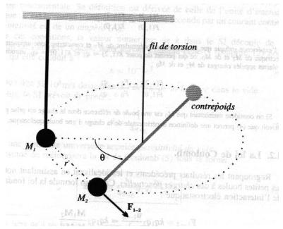
Un conducteur est solidaire d'une tige horizontale suspendue à un fil métallique fixé à son extrémité supérieure. On introduit un deuxième conducteur à l'intérieur de la balance. Les deux conducteurs initialement en contact sont électrisé par contact avec un troisième. Ils acquièrent des charges de même signe et se repoussent. La force exercée par 1 sur 2 est donc dirigée suivant  $M_1M_2$  et de  $M_1$  vers  $M_2$ .
