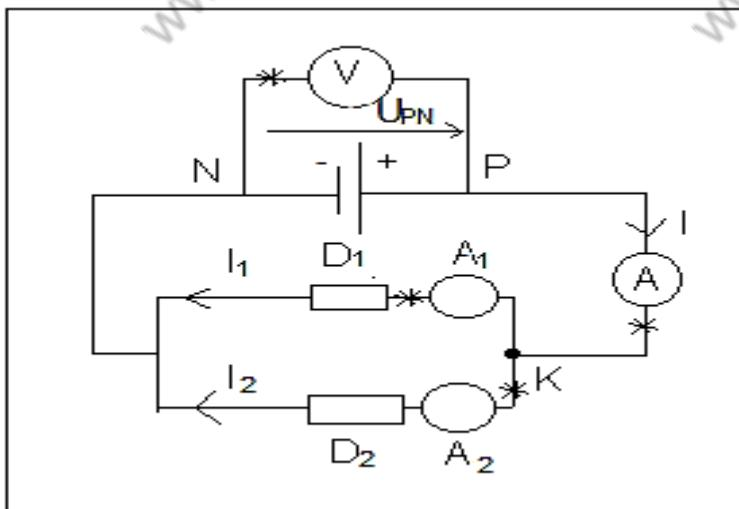
1- Les sens conventionnels des courants  $I_1$  et  $I_2$  sont représentés sur le schéma ci-dessous : à l'extérieur du générateur, le courant va du pôle positif vers le pôle négatif.
