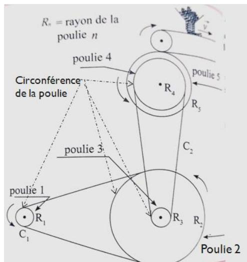
1. Établir que  $R_3 = \frac{v}{\omega_1} \cdot \frac{R_2 \cdot R_4}{R_1 \cdot R_5}$  (essayer de trouver les relations entre les vitesses).
