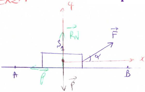
$$\textcircled{1} \quad V = \text{cte} \quad \text{d'après le principe d'inertie} \quad A.N \\ \sum \vec{F} = \vec{0}$$
